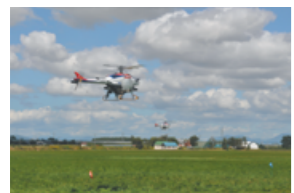
除草剤を狙った位置にだけ自動で散布していきます
