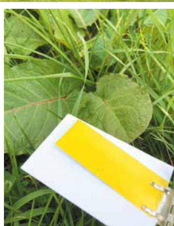
感水試験紙を用いて薬剤の付着や散布ムラを確認しました
