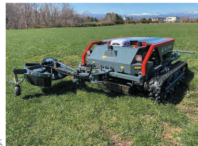
スマート草刈りロボット「Taurus80E」。80の由来は、メインブレードの幅が80cmなことから
